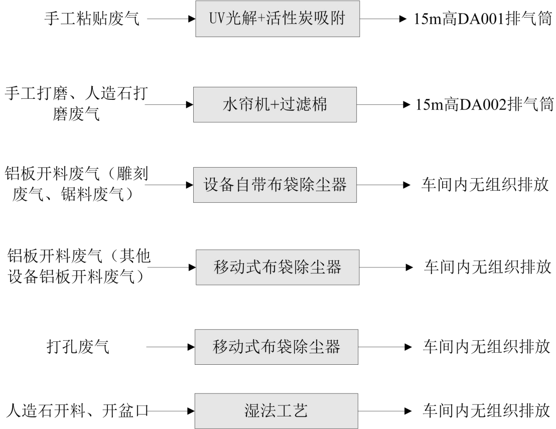
图 4-1 废气处理工艺流程图
