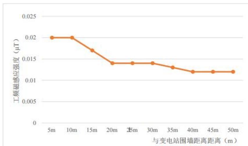
图 3-3 在中 110kV 变电站类比断面工频磁感应强度变化趋势图
